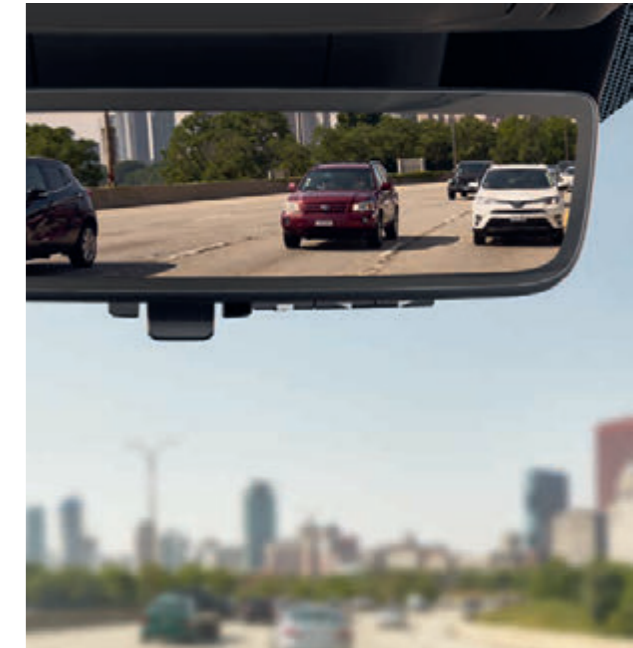
Smart-View-Mirror* Echtzeitbilder von einer auf der Heckscheibe montierten HD-Kamera gewährleisten eine ungehinderte Sicht, auch wenn der Kofferraum voll beladen ist.
