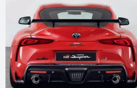
Schalldämpfer 2-flutig mit Sport-Carbon-Endblenden, Durchmesser: 100 mm
