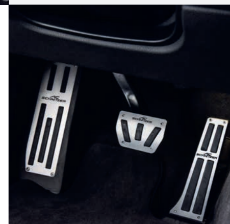
Fußstütze und Pedalauflagen aus Aluminium
